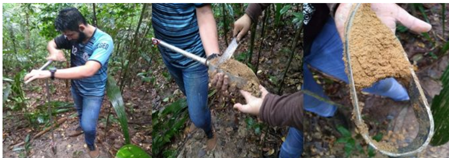
Figura 3 - Realização da Tradagem
