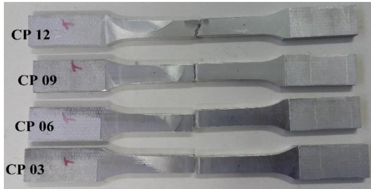
Figura 8 – Corpos de prova submetidos aos ensaios de tração
